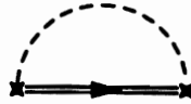
Рис. 3. Диаграмма собственной энергии электрона, описывающая перенормировку примесного интеграла столкновений за счет электрон-электронного взаимодействия. Двойная линия соответствует гриновской функции электрона с учетом электрон-электронного взаимодействия
