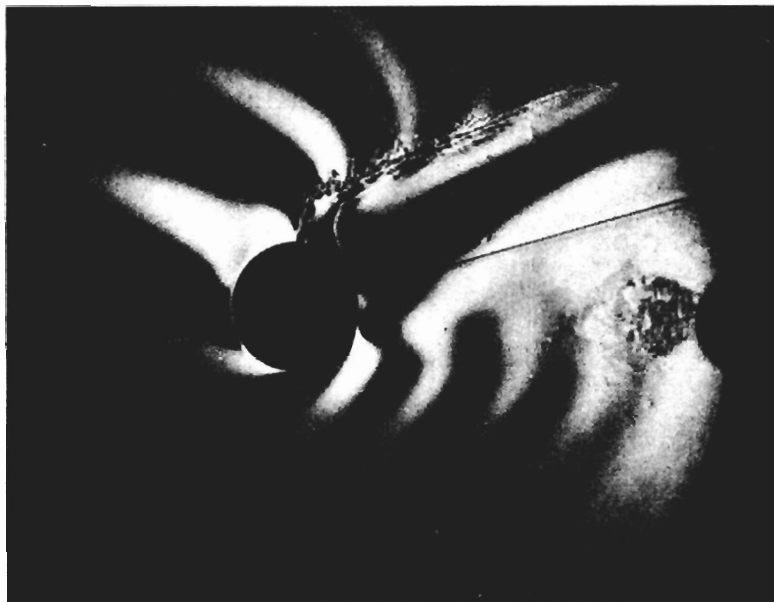
Рис. 1. Теневая фотография поля внутренних волн, излучаемых наклонно движущейся сферой в стратифицированной жидкости
