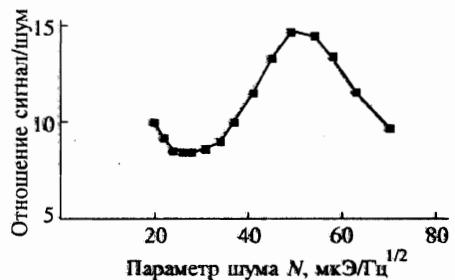
Рис. 4. Кривая стохастического резонанса для основной гармоники. Амплитуда переменного магнитного поля 9 \text{ мЭ} , частота 260 \text{ Гц}
