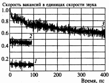
Рис. 3. Динамика вакансий в равновесном кристалле: кривые 1, 2 — сохранение малых и средних (0.1 и 0.45 от скорости звука) скоростей движения дефектов в цепи, окруженной подвижными соседями, кривая 3 — замедление быстрого (0.9 от скорости звука) дефекта: переход на стационарный солитонный режим движения с меньшей скоростью (~ 0.6 от скорости звука)
