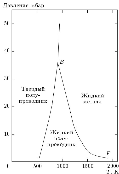
Рис. 1. Фазовая диаграмма селена: BF — линия перехода изолятор–металл по данным [3] и [25], соответствующая минимальной металлической проводимости около 200 \text{ Ом}^{-1} \cdot \text{см}^{-1}
