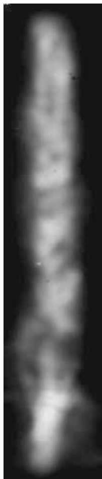
Рис. 8. Азимутально-аксиальные неоднородности излучения участка пинча, диаметр пинча приблизительно 0.8 мм
