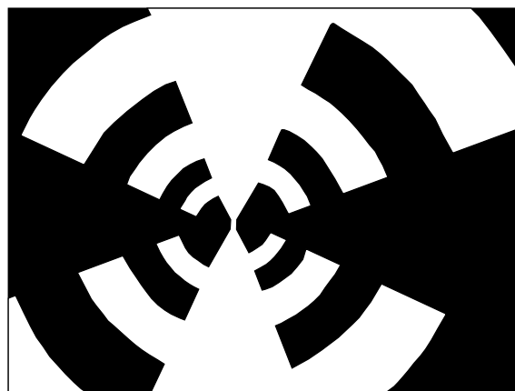
Рис. 2. Оптическое изображение интегральной структуры, содержащей логопериодическую антенну и микромостик из MgB_2 , пересекающий бикристаллическую границу в центре
