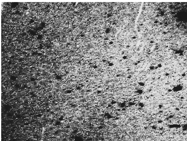
Рис. 10. Рентгеновское изображение материала мишени ЛТС, изготовленной из триацетатцеллюлозы плотностью 10 \text{ мг/см}^3 с 10 вес. % меди. Толщина объекта 300 мкм. Длина волны \lambda \approx 4.5 \text{ нм} , время экспозиции около 1 нс
