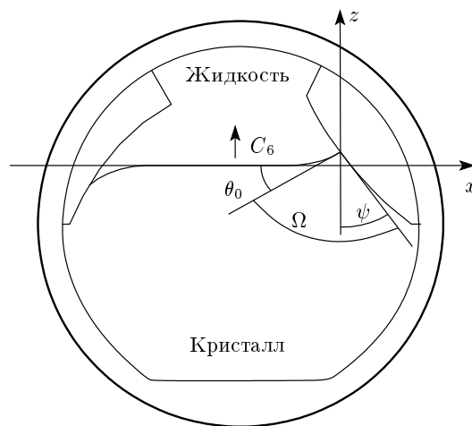
Рис. 1. Поперечное сечение экспериментальной камеры
