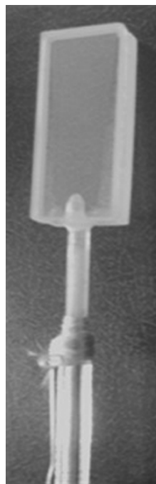
Рис. 1. Фотография микроячейки (микроразмеры — расстояние между внутренними поверхностями окон). Прямоугольные окна: 8 мм × 30 мм, толщина 2 мм, материал — кристаллический сапфир. Зазор L (между внутренними поверхностями окон) плавно изменяется по вертикали в интервале от 1 мкм в верхней части до 90 мкм в нижней части. Вертикальный (боковой) отросток заполнен металлическим Rb. К верхней границе столба металлического Rb (которая определяет давление паров внутри ячейки) прикреплен (стеклонитью) конец термомпары
