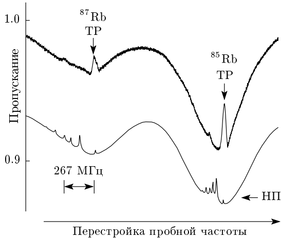
Рис. 3. Верхняя кривая — содержащий ТР спектр пропускания пробного излучения при толщине L = \lambda = 780 нм, слева и справа соответственно для атомов ^{87}\text{Rb} и ^{85}\text{Rb} ; для атомов ^{85}\text{Rb} контраст составляет около 40 %, \gamma_{DR} = 29 МГц, P_c = 2 мВт, P_p = 2 мкВт. Температура СМЯ равна 130^\circ\text{C} . Нижняя кривая — реперный спектр НП
