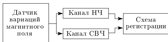
Рис. 2. Функциональная схема двухканального ТКМОН
