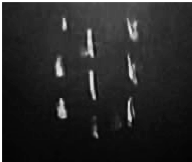
Рис. 5. Анизотропный плазменно-пылевой кристалл, состоящий из вертикально ориентированных цепочек, при температуре T = 170 К. Заметно преобладающее вертикальное колебание пылевых частиц в цепочке
