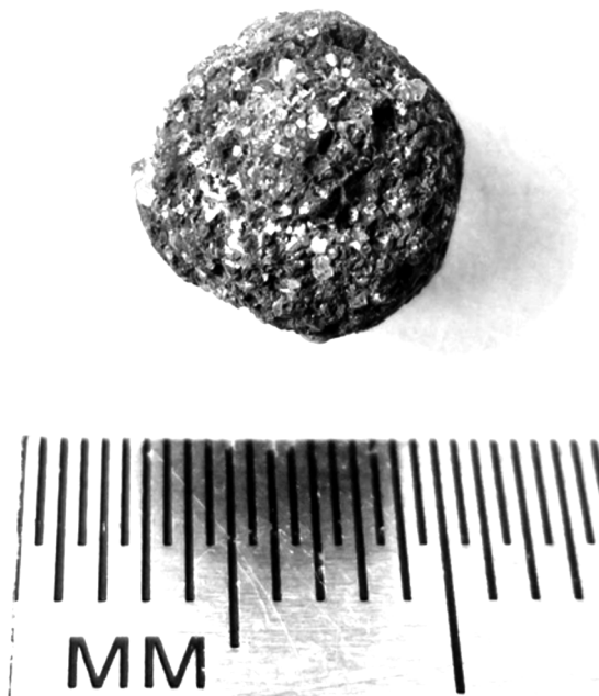
Рис. 8. Образец искусственного астероидного вещества шаровидной формы диаметром 4.5 мм и массой 0.1 г
