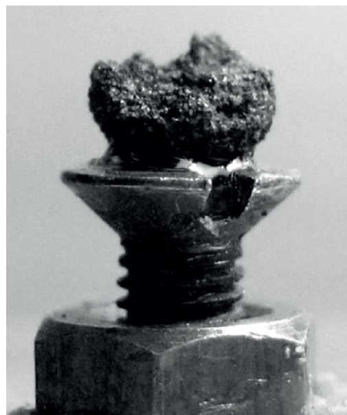
Рис. 17. Остатки шарового макета после пяти выстрелов при пятне фокусировки радиусом 160 мкм и полной энергии E = 51.8 Дж
