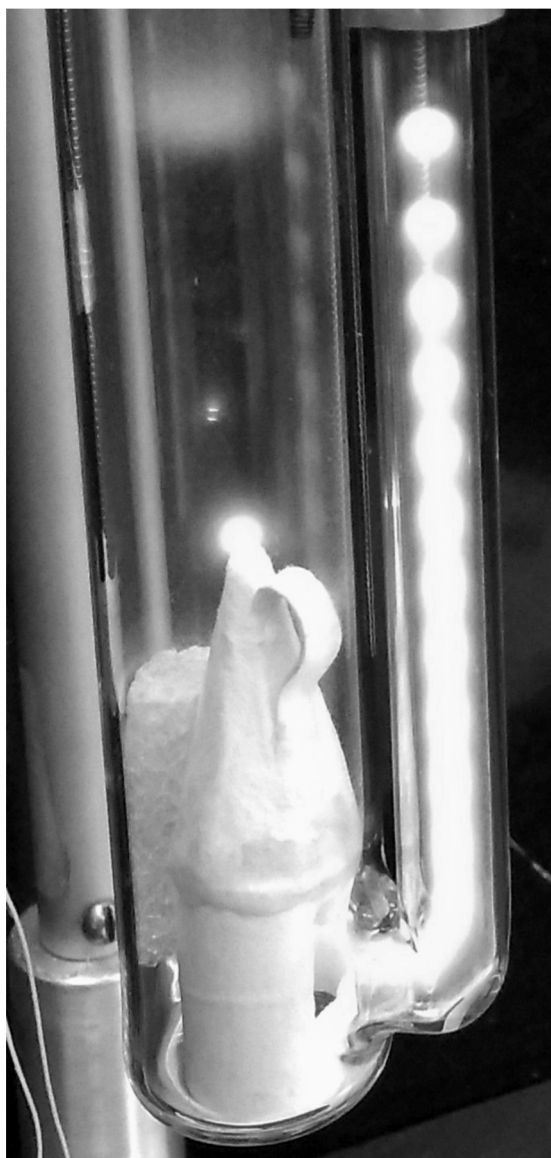
Рис. 4. Фотография нижней части трубки с горящим тлеющим разрядом
