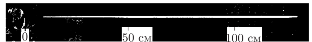
Рис. 7. Плазменный канал бesselева пучка J_0(r) [13]: \lambda = 1.06 мкм, D = 4.5 см, N = 5 , \theta = 1^\circ , L = 1.3 м, d = 50 мкм
