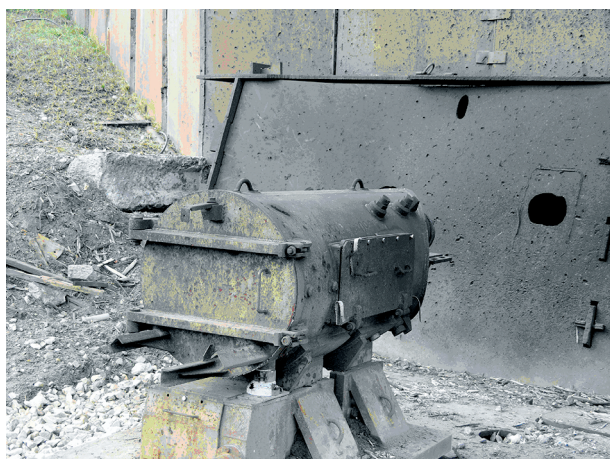
Рис. 8. Взрывозащищенная камера, используемая для размещения регистраторов изображений рентгенографируемого устройства при проведении взрывных экспериментов
