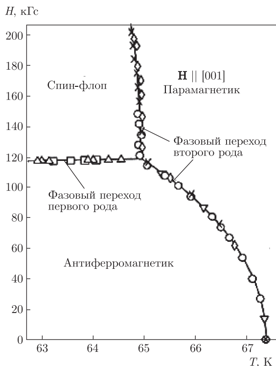
Рис. 6. Магнитная фазовая диаграмма MnF_2 , демонстрирующая существование бикритической точки [9]
