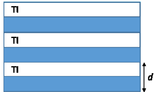
Рис. 1. Схематическое изображение многослойной структуры. Незакрашенные участки обозначают слои топологических изоляторов (π), а закрашенные — обычные зонные изоляторы
